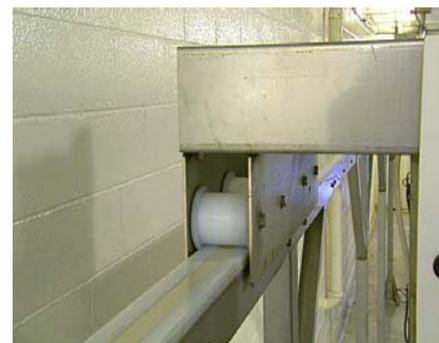
Система сушки - самостоятельная арка с вентиляторами. Делается это для увеличения производительности, пока автомобиль выезжает под сушкой – следующий уже может въезжать на пост мойки.
