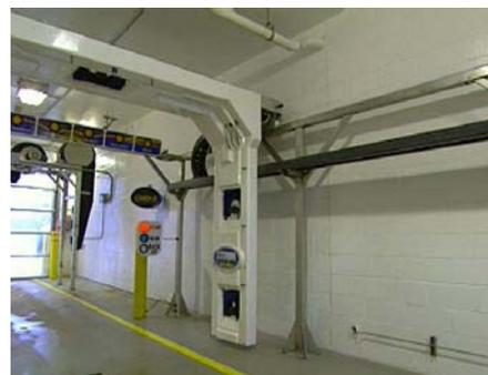
Оригинальная система сканирования избавляет от мешающих конструкций на полу и открывает полный обзор за процессом мойки. Минимальные требования к габаритам помещения, быстрота установки и низкие затраты на обслуживание самого комплекса сохранят ваши деньги.
